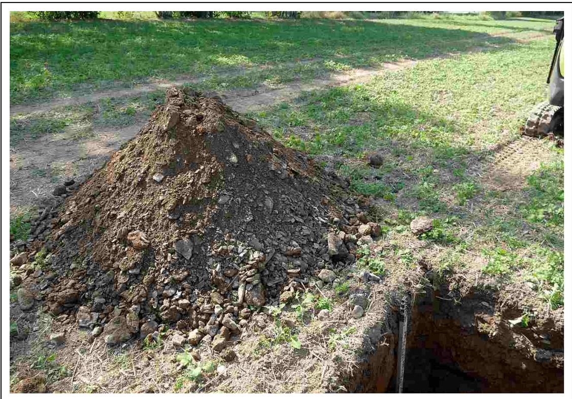
Foto 2: Versickerungsversuch VV 1: beim Anlegen des Schurfes gelöster Bodenaushub
