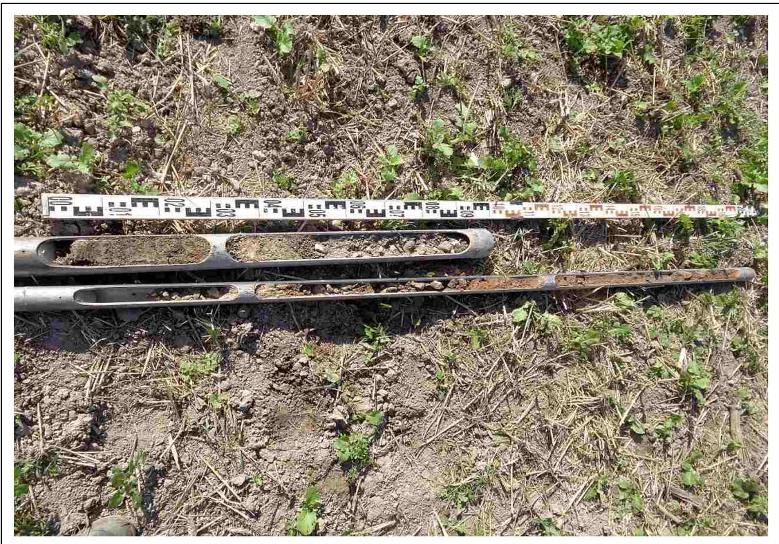
Foto 12: Versickerungsversuch VV 3: zugehörige Bohrung BS - VV 3
