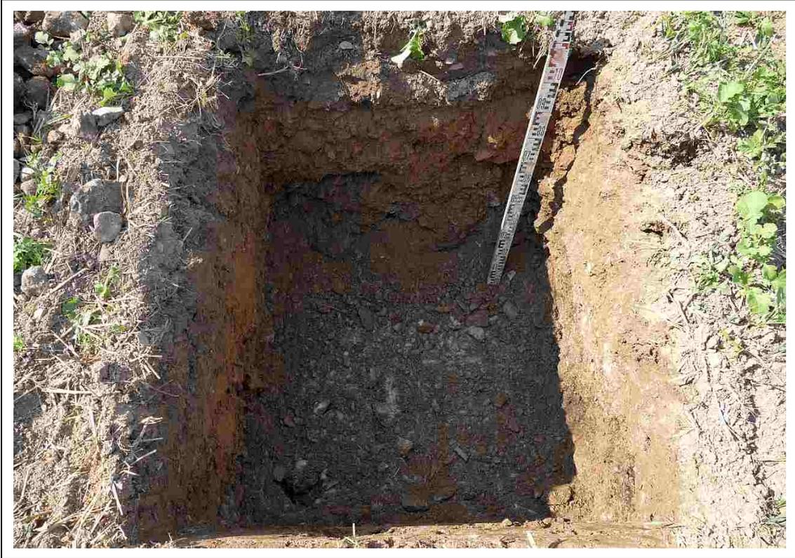
Foto 1: Versickerungsversuch VV 1: fertig gestellter Schurf vor der ersten Befüllung mit Wasser
