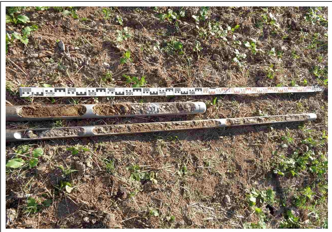
Foto 4: Versickerungsversuch VV 1: zugehörige Bohrung BS - VV 1
