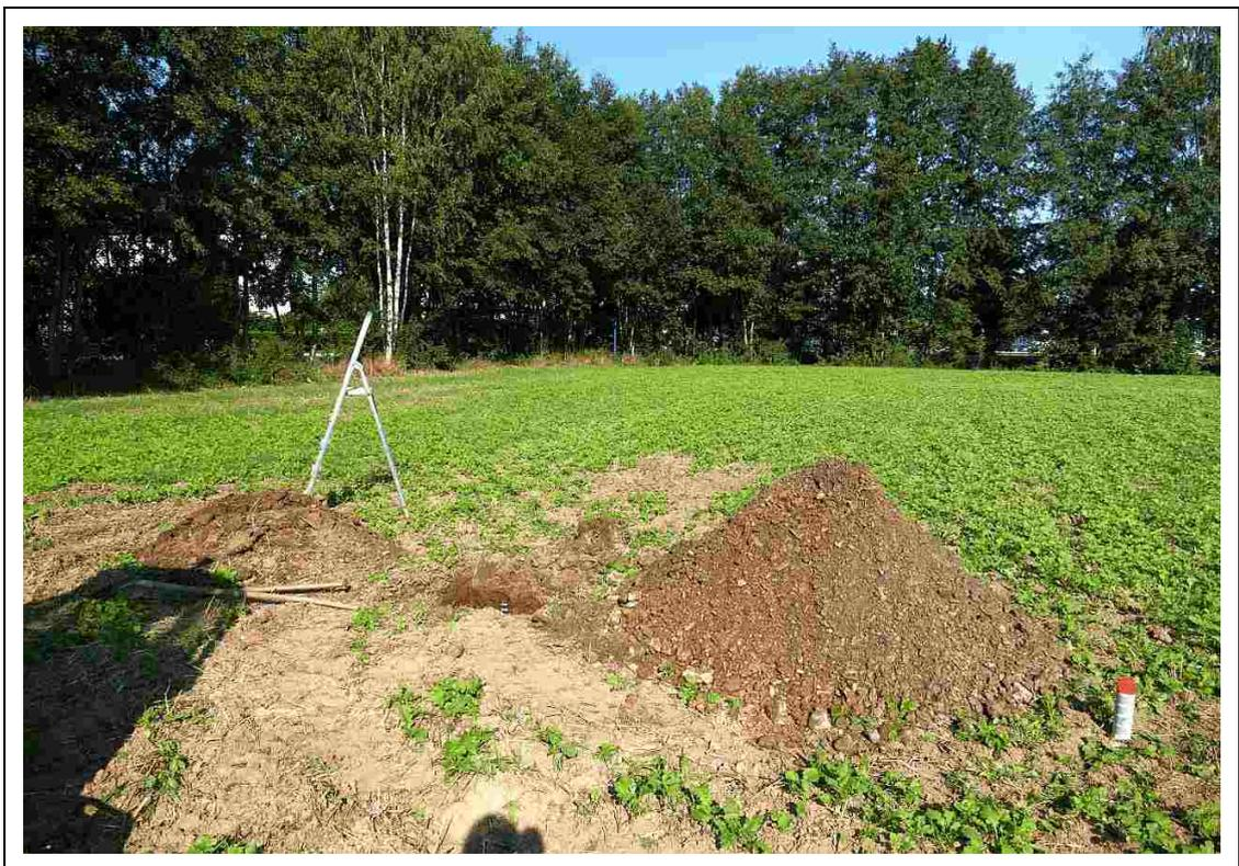
Foto 6: Versickerungsversuch VV 2: beim Anlegen des Schurfes gelöster Bodenaushub
