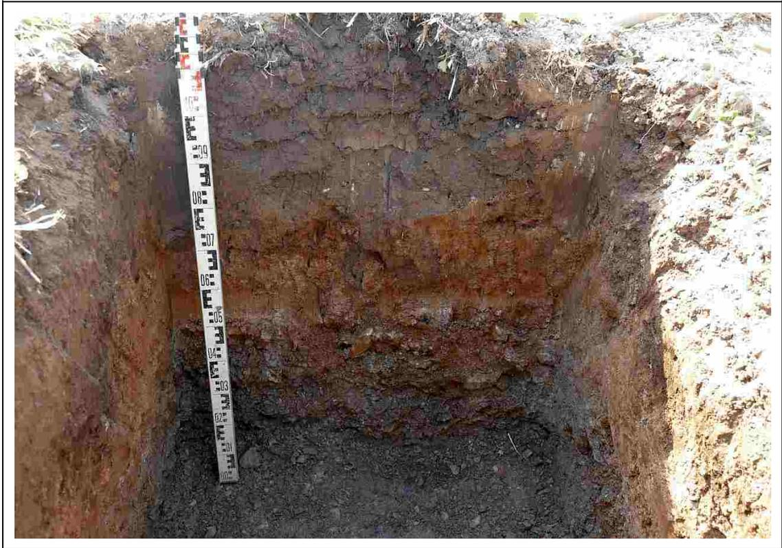
Foto 5: Versickerungsversuch VV 2: fertig gestellter Schurf vor der ersten Befüllung mit Wasser
