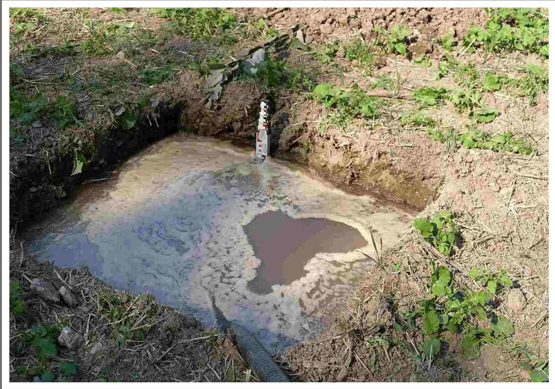
Foto 3: Versickerungsversuch VV 1: mit Wasser befüllter Schurf
