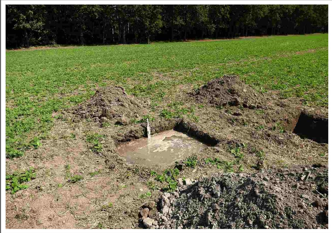
Foto 11: Versickerungsversuch VV 3: mit Wasser befüllter Schurf
